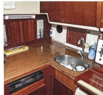
Die Pantry bietet angemessenen Platz und Stauraum, die Kunststoffoberflächen sind in Holzimitat. Die Klappe rechts gibt Zugang zum Mülleimer in der Backskiste.
