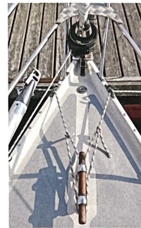
Auf einen Ankerkasten hat die Werft verzichtet, vorn der Einfüllstutzen für den Wassertank.
