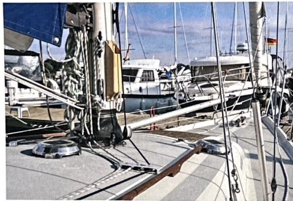
Lange Handläufe finden sich sowohl an wie unter Deck, zahlreiche Lüfter sorgen für Ventilation. Die nachgerüstete Leinenumlenkung erfordert zusätzliche Tieroder zwischen Deck und Mast.
