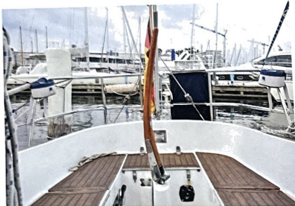
Neben zwei Backkisten gibt es einen zusätzlichen Heckstauraum, die Deckel bestehen aus Sperrholz, die Teakstäbe sind nachgerüstet. Die Ruderwelle läuft in soliden Bronzelagern.
