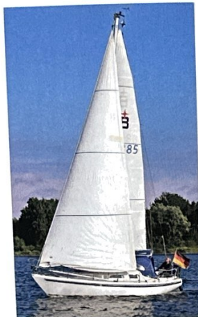
Die Ballad trägt ein klassisches IOR-Topprigg mit großer Genua, das Großsegel ist nur schmal.
