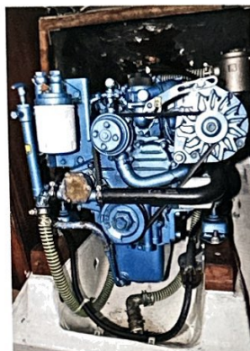
Die Maschine unter dem Niedergang ist sehr gut zugänglich und verfügt über eine eigene Bilge. Im Testboot steht ein Austauschmotor.
